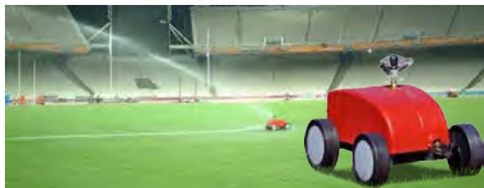
AFFRKIT - SISTEMA DE IRRIGAÇÃO MÓVEL / SPRINKLER CART O sistema de irrigação automático para campos desportivos e grandes superfícies relvadas. Incluído transportador e mangueira de 100m de 1", com rodas pneumáticas. Através do aspersor semicircular, permite que o robot avance no relvado seco, deixando para trás o irrigado. Peso 33kg. Automatic Irrigation system for sportsfields and large playing areas. Includes 100m 1" water hose and hose transporter with pneumatic wheels. Thru the semi circle sprinkler the robot cart advances thru the lawn, leaving behind irrigated lawn. Weight 33 kg.
